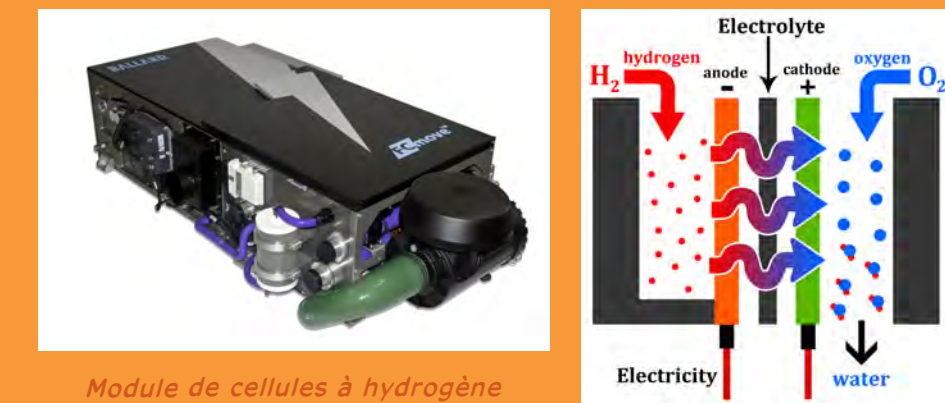
Diagramme d'une cellule à hydrogène
